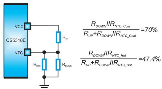
上面式中 $R_{NTC\_Cold}$ 为NTC电阻在设定的低温点所对应的阻值，而 $R_{NTC\_Hot}$ 为NTC电阻在设定的高温点所对应的阻值。由于 $R_{DOWN}$ 和 $R_{UP}$ 这两个电阻可以分别独立设定低温和高温窗口，使得CS5318E可以满足大部分NTC电阻型号，这为应用带来了极大的便利。电阻 $R_{DOWN}$ 和 $R_{UP}$ 与NTC电阻之间的关系可以通过上述定义给出下列公式：
